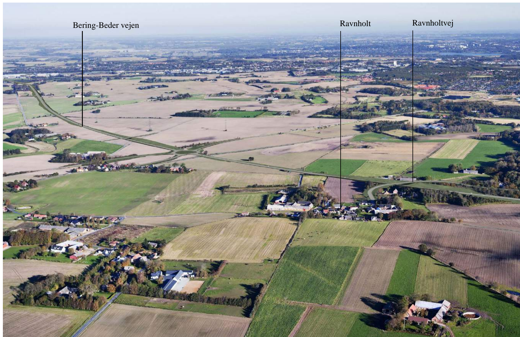
Figur 40 Luftvisualisering af passagen ved Ravnholt. Ravnholtvej føres over Bering-Beder vejen, som ligger i delvis afgravning. Luftvisualisering 17.
