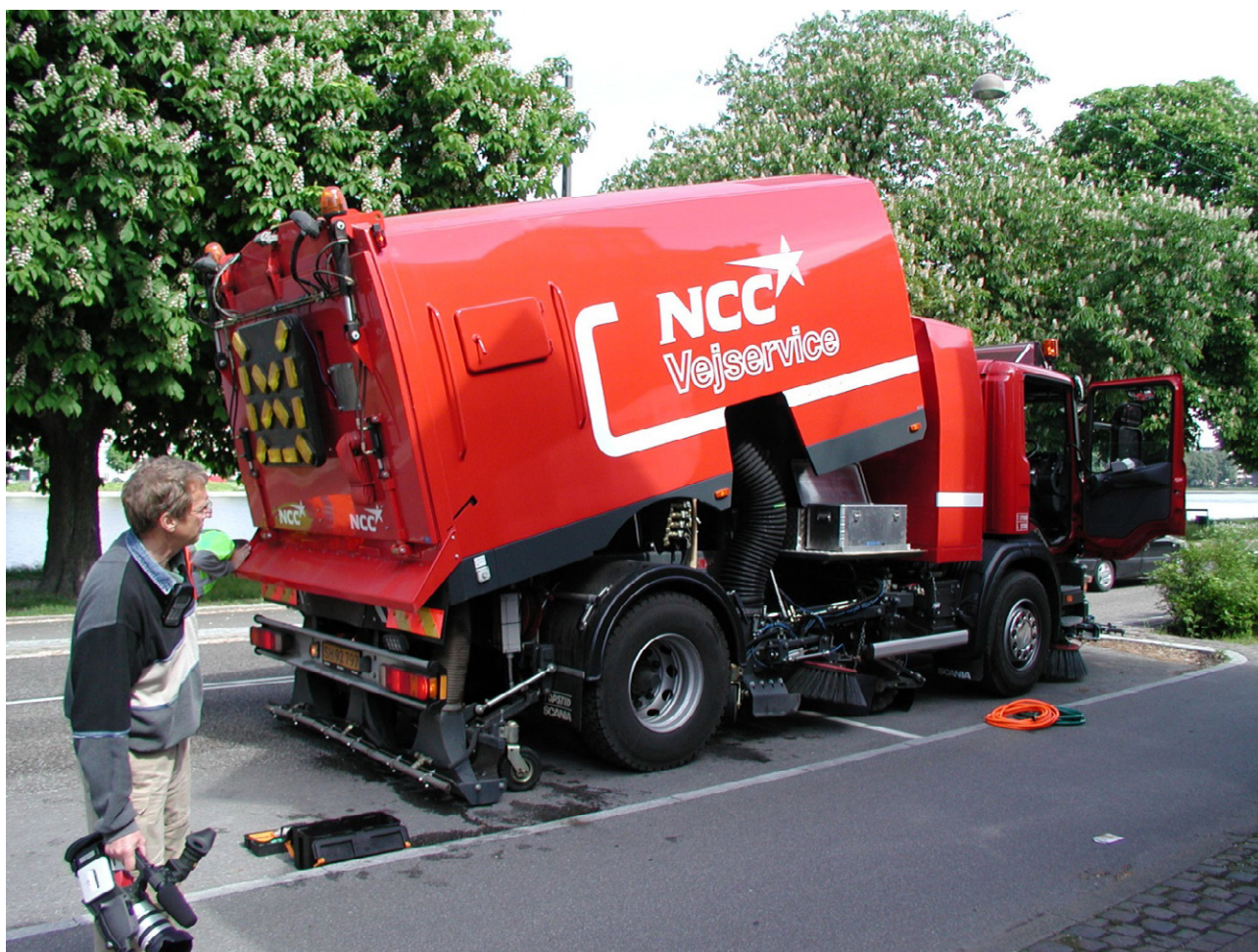
Figur 7.1: Spulebil anvendt til rensning af drænasfalt på Øster Søgade.
