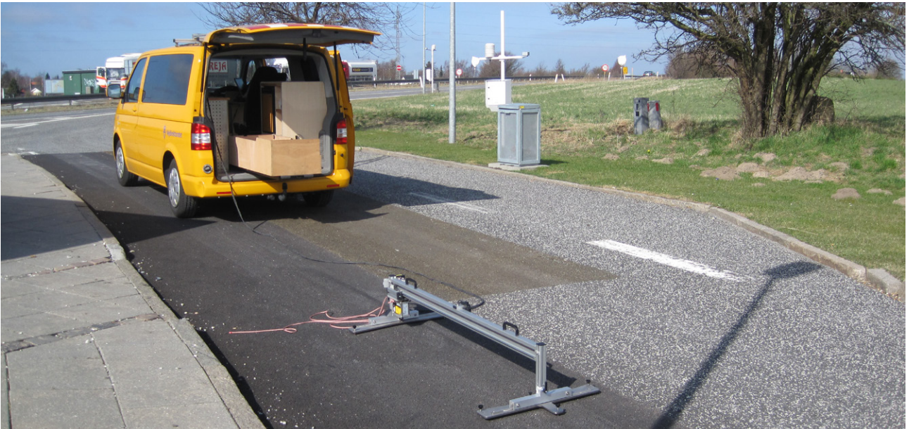
Figur 4.5: Teksturmålinger på DA 8-belægningen ved Arnakke udført med Vejdirektoratets laserskinne.
