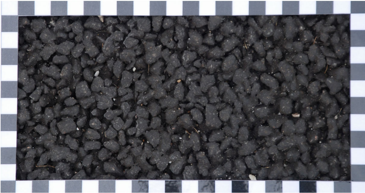
Figur 4.2: Overfladen af DA 8-belægningen ved Arnakke da den var to måneder gammel. Størrelsen af de sorte og hvide tern er 10x10 mm.
