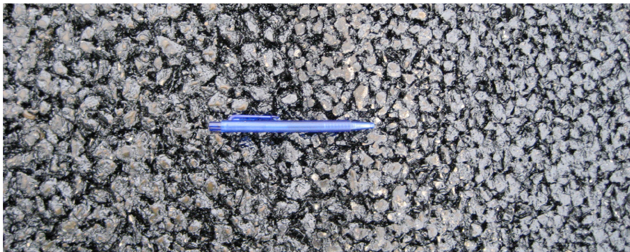
Figur 3.7: Nærbillede af de nyudlagte DA8 (til højre) og DA11 (til venstre) belægninger på Eksportvej (Foto NCC Roads).
