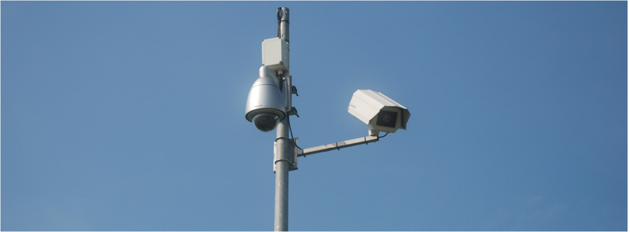
Figur 4.4: Termokamera samt et online videokamera ved forsøgsbelægningerne ved Arnakke rasteanlægget.
