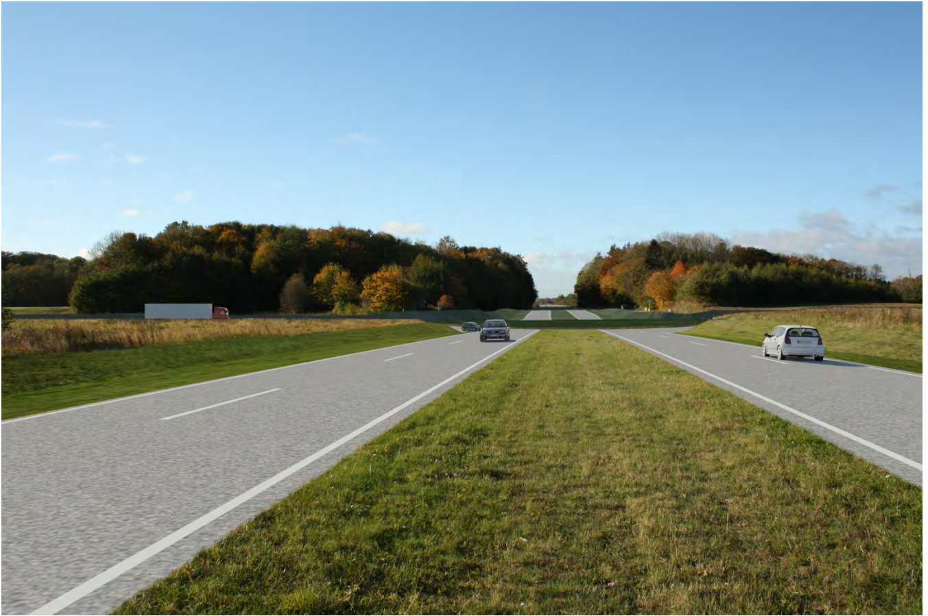
Figur 53 Visualisering af Bering-Beder vejens krydsning af Landevejen, som sker i en rundkørsel, der er sænket i forhold til den eksisterende vej. Terrænvisualisering 8.
