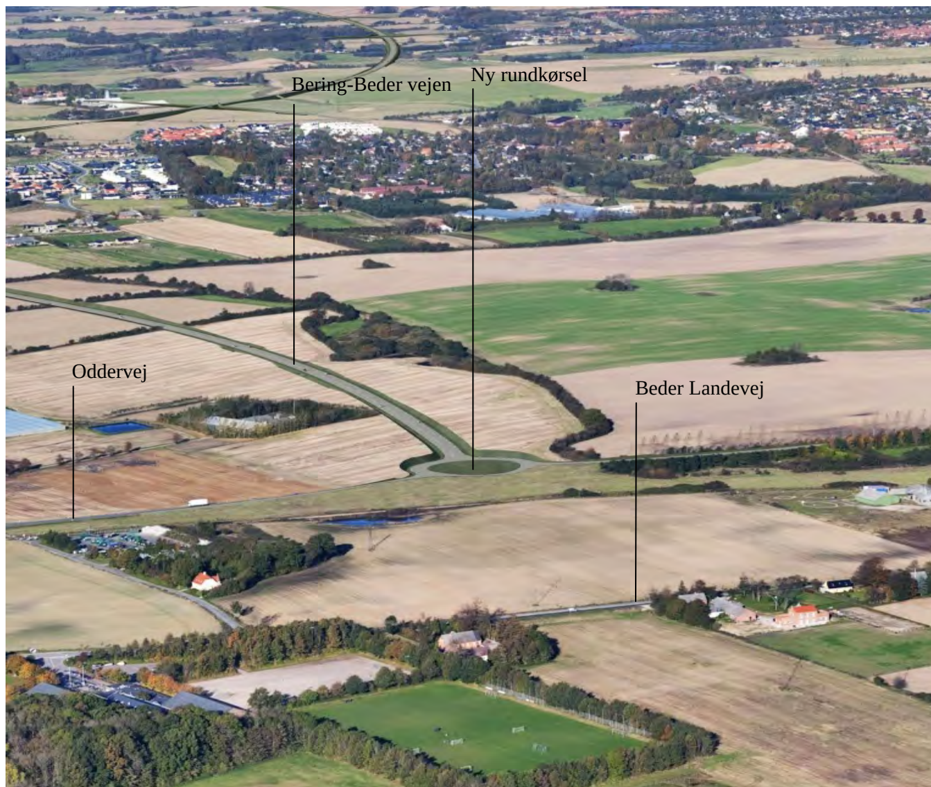
Figur 37 Luftvisualisering af Bering-Bedervejens tilslutning til Oddervej. Den kommende rundkørsel er placeres lidt lavere i landskabet vest for Oddervej. Luftvisualisering 4.
