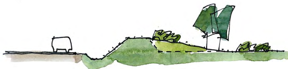
Landskabeligt tilpasset støjvold, snit
