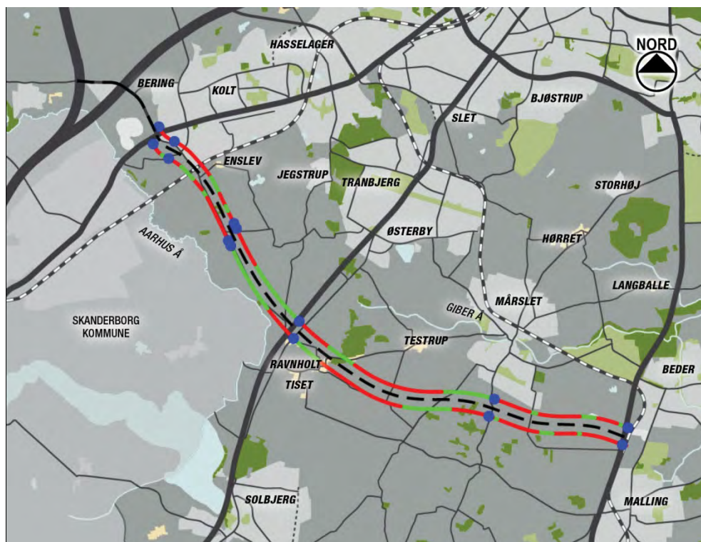
Figur 4.22 Overhalingssigt ved alternativ C. De grønne streger angiver strækninger med overhalingsigt.
