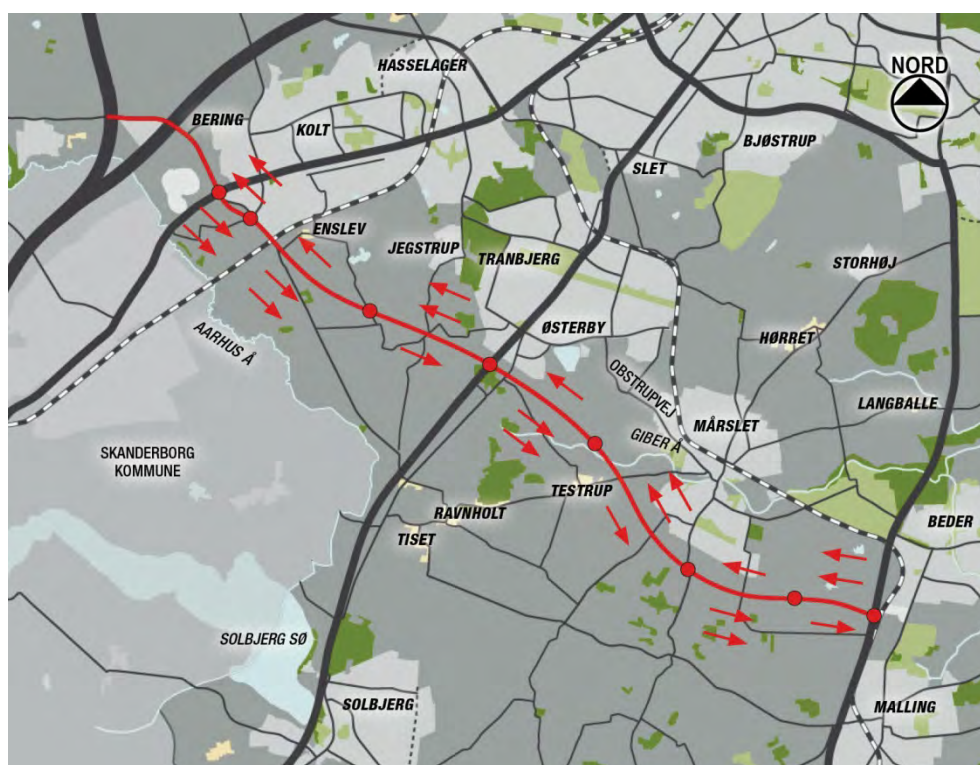
Figur 4.13 Mulig sporfordeling på 2+1 vej for alternativ A.
